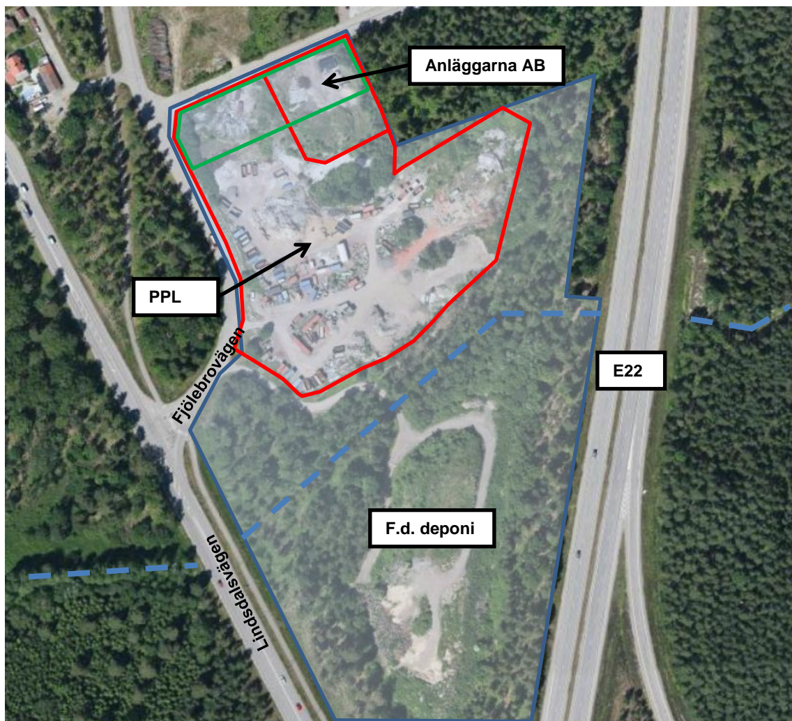
Figur 2. Karta från hitta.se över aktuellt undersökningsområde inom Fjölebo (svagt tonat område). Ungefärligt läge av PPLs och Anläggarna ABs verksamhetsområde framgår av rödmarkerat område. F.d. deponi ligger främst i södra delen av området men viss utfyllnad har även skett inom PPLs verksamhetsområde. Grönmarkerat område visar ungefärligt läge inom vilket bostäder planeras. Blåstreckad linje visar läge på grävt dike.
