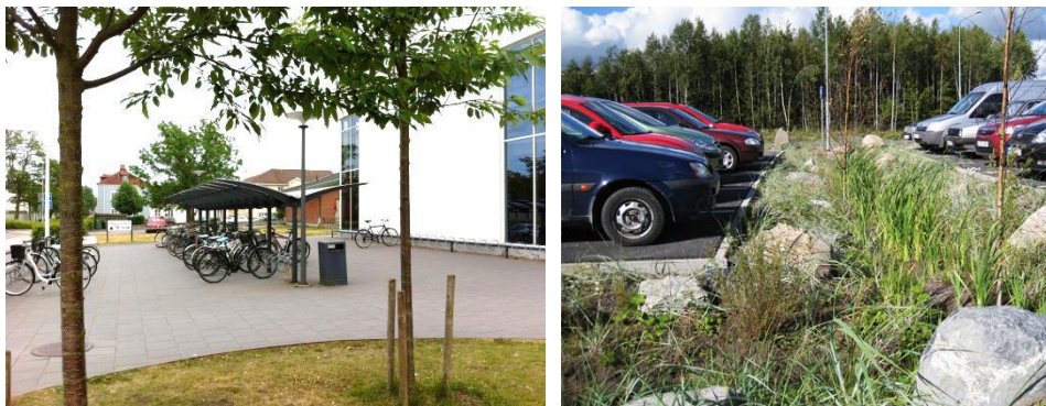
Bild till vänster: exempel på cykelparkering och trädplantering intill entrén vid Kalmar simhall, bild till höger: exempel på parkering med infiltrationsytor för lokalt omhändertagande för dagvatten
