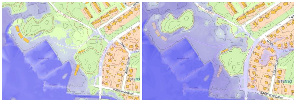
Modellering av översvämning upp till 1,5 meter över nollplanet (till vänster) och upp till 2,5 meter över nollplanet (till höger).
