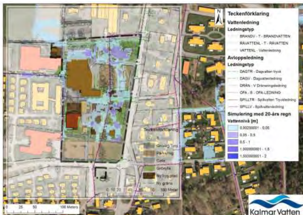
Figur 7 Exploatering enligt föreslagen illustration, vatten-, spill- och dagvattenledningar samt simulering av marköversvämning vid ett 20-års regn (dagens situation).
