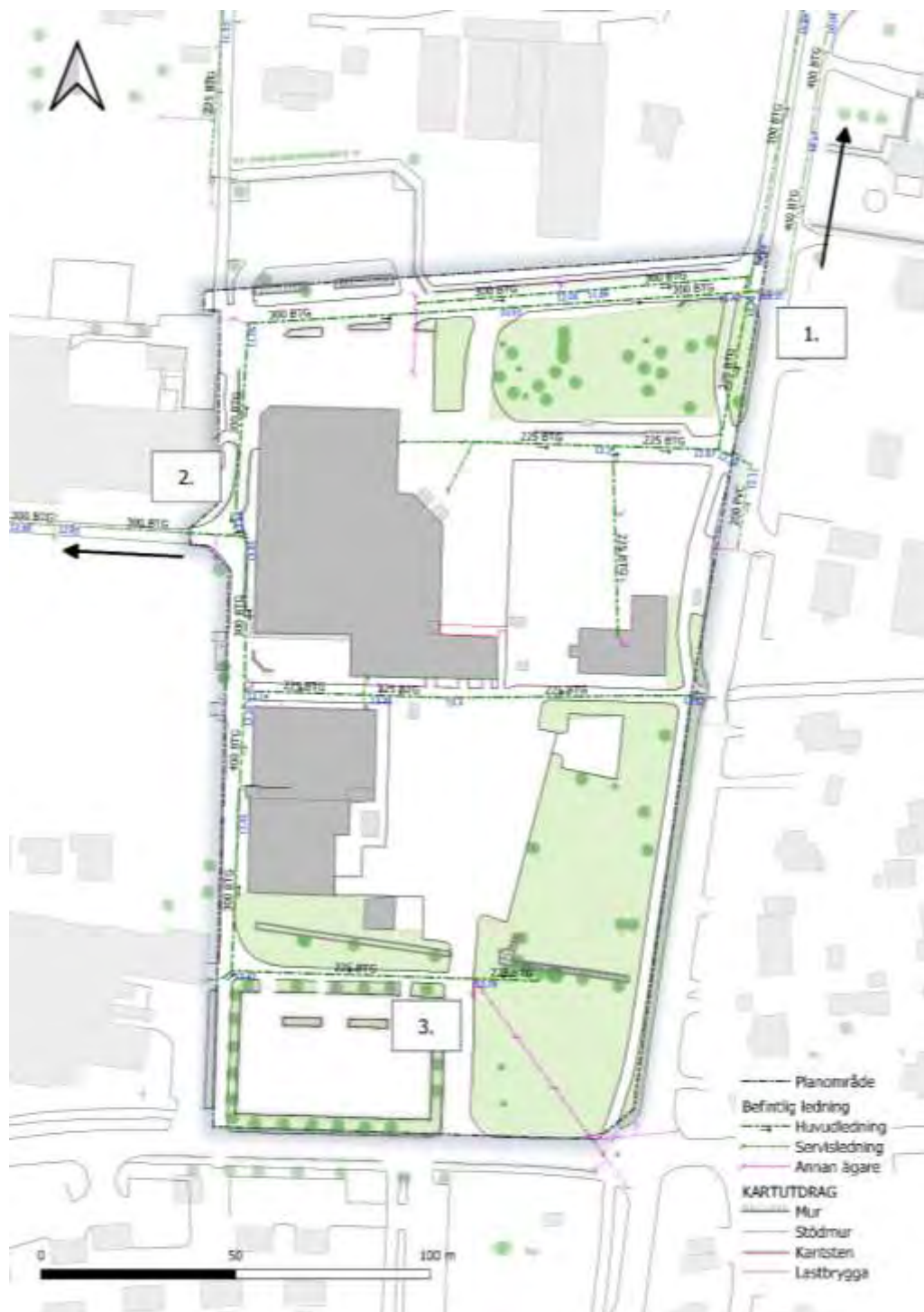
Figur 5 Utredningsområdet och befintliga dagvattenledningar.
