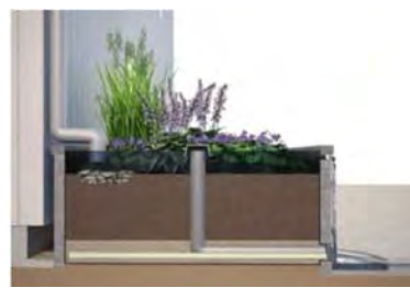
Principritning av ytligt fördröjningsmagasin enligt bifogad dagvattenutredning.
