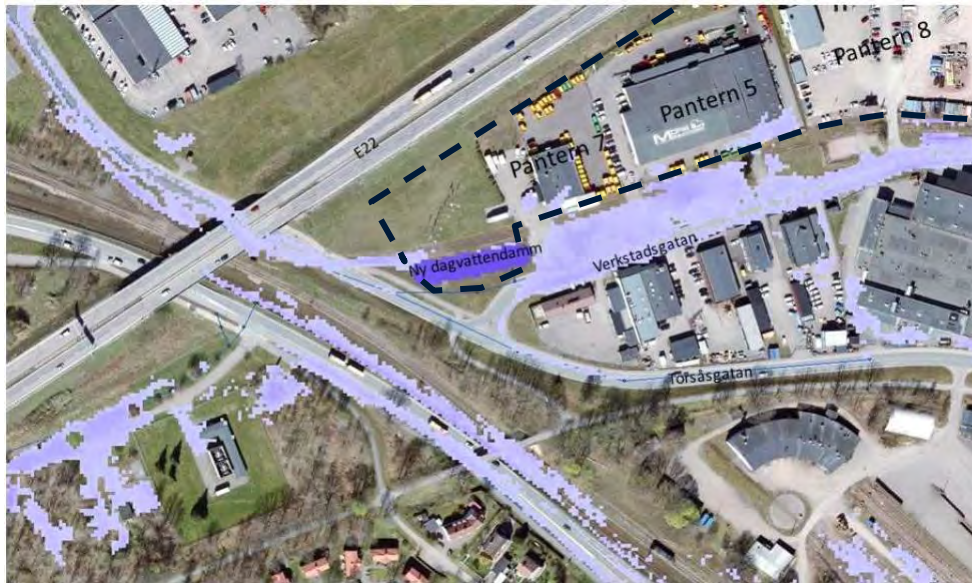
Dagvattensimulering för ett regn med 20-års återkomsttid, inklusive klimatfaktor och föreslagen dagvattendamm efter planens genomförande
