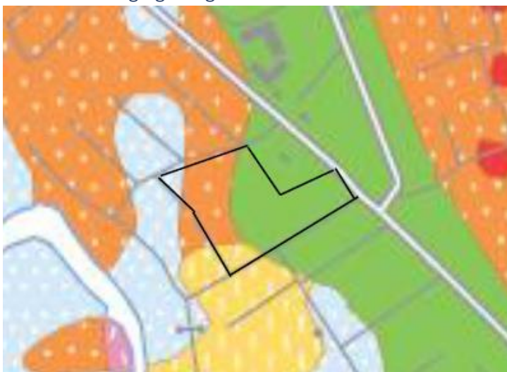
Bild 4.1; Utdrag ur SGUs jordartskarta med aktuellt område markerat. Grön färg markerar isälvssediment, orange postglacial finsand, gul postglacial silt, ljusblå sandig morän och rött berg i dagen.
