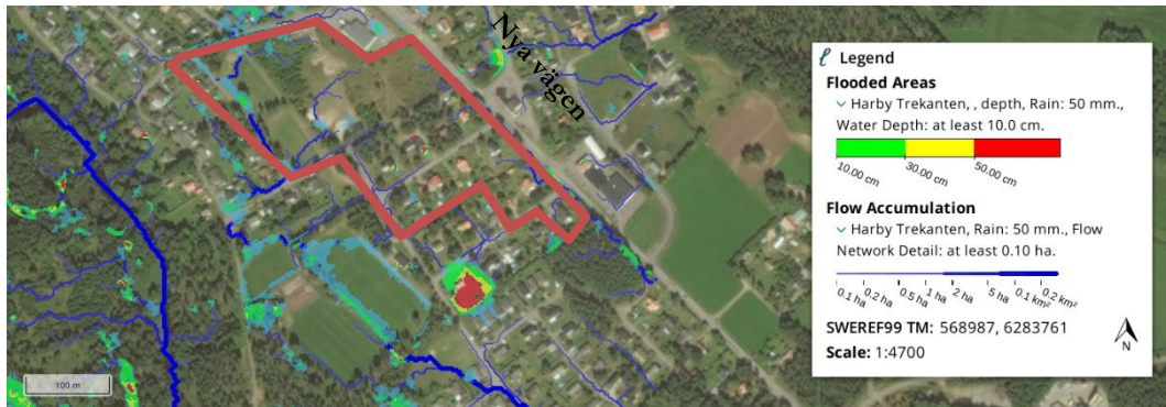
Figur 3. Skyfallsanalys SCALGO, 50 mm regn, grönt område visar vattendjup på >0,3 m, gult 0,3- 0,5 m och rött >0,5 m.
