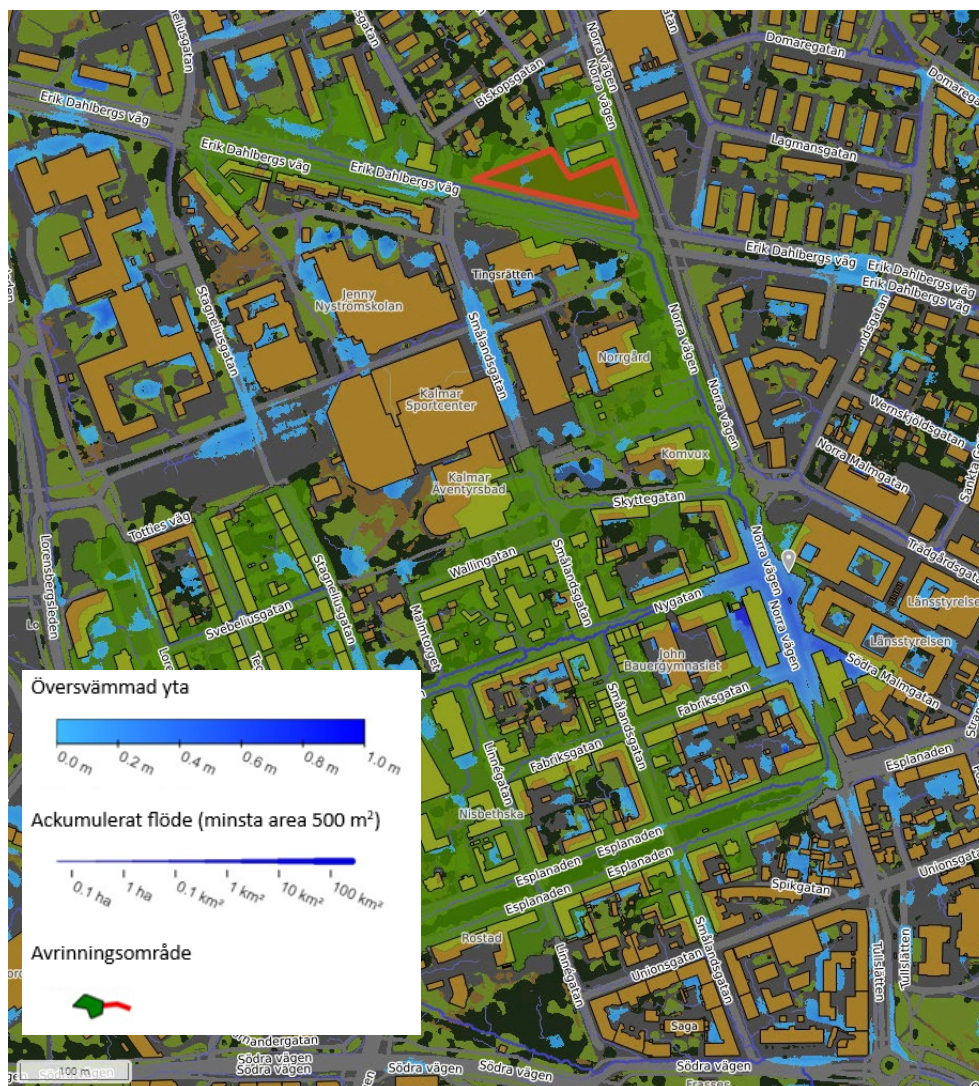
Figur 5. Resultat Scalgo, 50 mm regn, med hårdgjord mark inom planområdet
