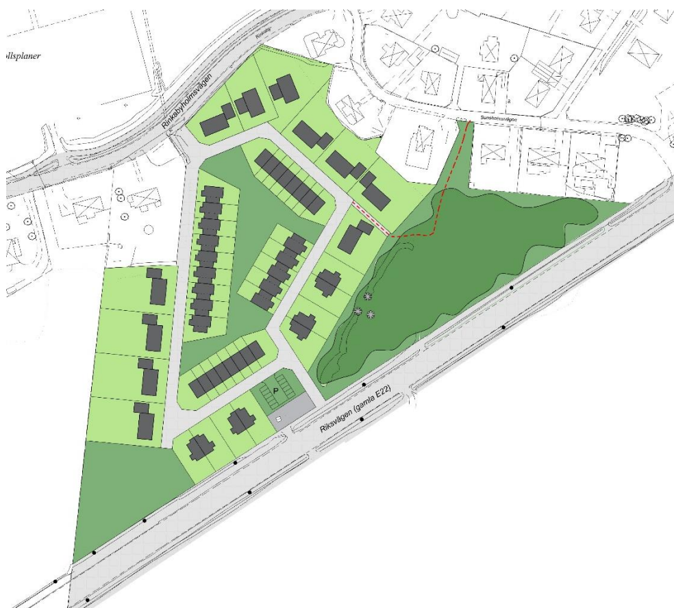
Illustrationsplan. Röd, prickad linje anger planerad gång- och cykelväg. Illustrerad parkering avser besöksparkering, parkering för boende sker inom respektive fastighet.
