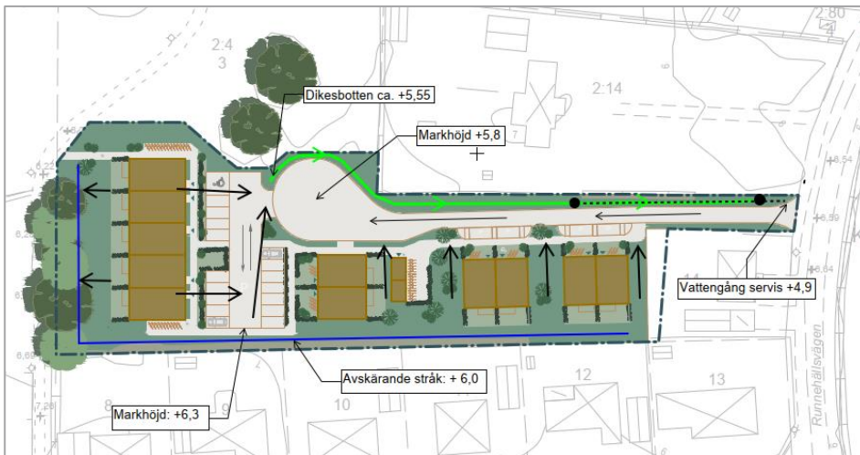
Figur 11. Illustrationskiss över planområdet – förslag 1 (flerbostadshus och par- eller radhus) . Gröna pilar illustrerar flödesriktning i svackdiket, blå linje avskärande stråk, svarta pilar generell marklutning, svart streckad linje illustrerar dagvattenledning och svarta cirklar kupolbrunnar.
