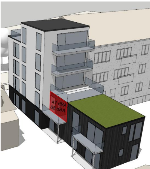
FIGUR 3 – LJUDNIVÅ MOT FASAD BAKSIDA, MED OCH UTAN BULLERSKÄRM FÖR NUTID
