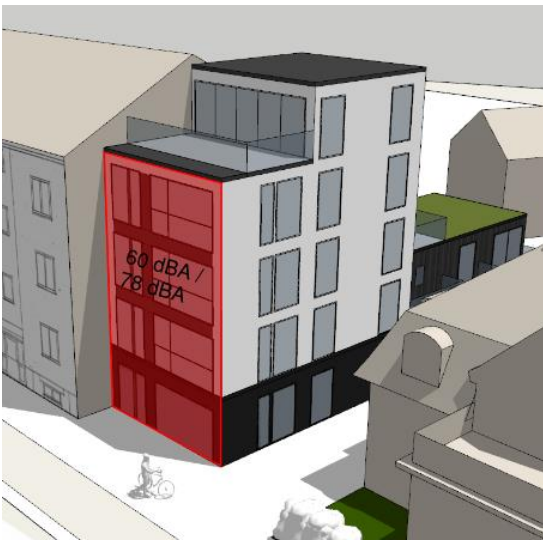
FIGUR 1 - FIGUR FÖR BULLERNIVÅ MOT FASAD NUTID
