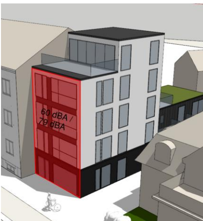
FIGUR 2 – FIGUR FÖR BULLERNIVÅ MOT FASAD ÅR 2040
