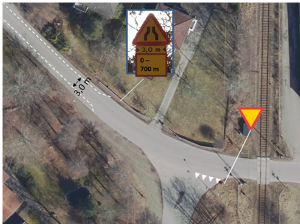
Sydöstra änden. Vägrenarnas bredd blir över lag ca 1,2-1,3 m.
