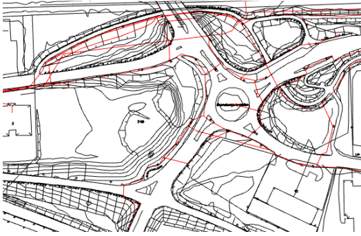
Befintliga elledningar i området
