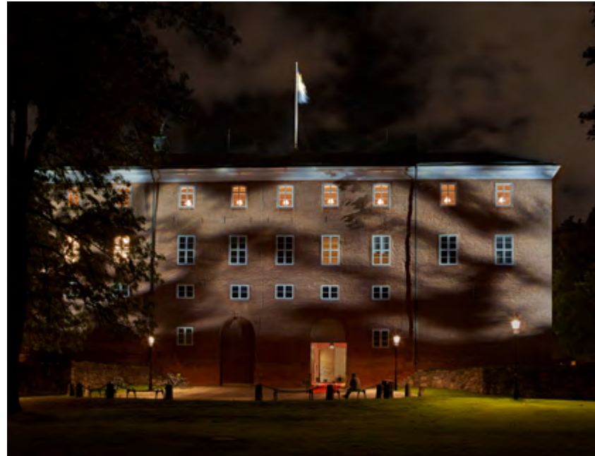
Att belysa landmärken så att ljuset ser ut att vara månljus kan ge en fin effekt. Fotografi: ÅF Lighting
