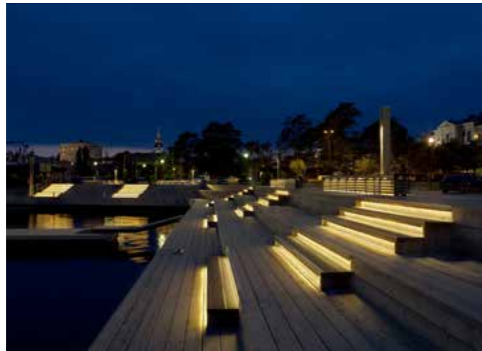
Solbrygga i Hudiksvall. Ljusdesignen av bryggorna bygger på helt integrerade lösningar. LED-armaturer är integrerade i såväl trappstegen, under bänkarna, som stolpar i bänkarna och i räcken. I mörker framträder detaljer i bryggorna med spännande kontraster och ljus som trappar ner mot vattnet. Dagtid finns inga synliga armaturer som inverkar i trälandskapets utformning. Fotografi: Mikael Silkeberg
