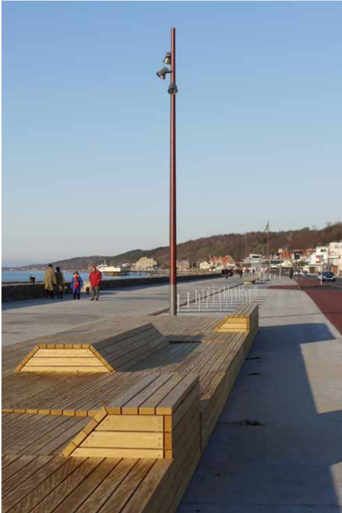
Helsingborgs Strandpromenad. Att anpassa synligt belysningsmaterial till platsen är viktigt. Här har en trästolpe använts vid en hamnpromenad vilket känns passande. Strålkastarna är lackerade i en nyans som andra urbana element har i området. Fotografi: Kathrine Brandt
