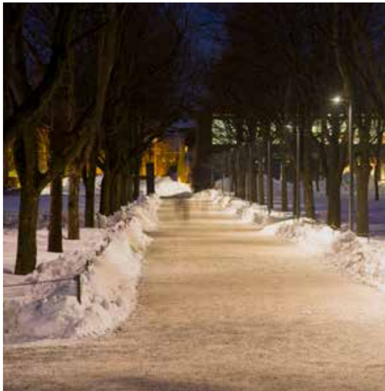
Välavbländade armaturer gör att miljön kommer i fokus istället för belysningspunkterna. Ögat kan här lättare slappna av och läsa av omgivningen än om armaturen hade haft ett kupa glas eller lysande armaturdelar. Fotografi: Halvor Gudim
