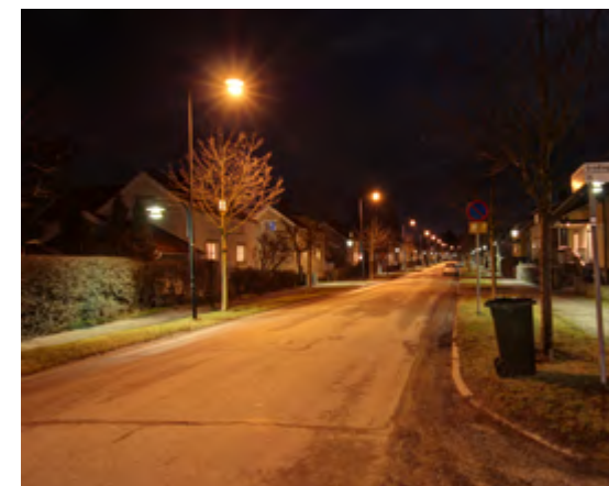
Färgåtergivning, högtrycknatrium. Högtrycknatrium har en låg färgåtergivning och ger ett monokromatiskt ljus vilket ger ett platt intryck då färgerna smälter ihop och det är svårt att urskilja detaljer.
