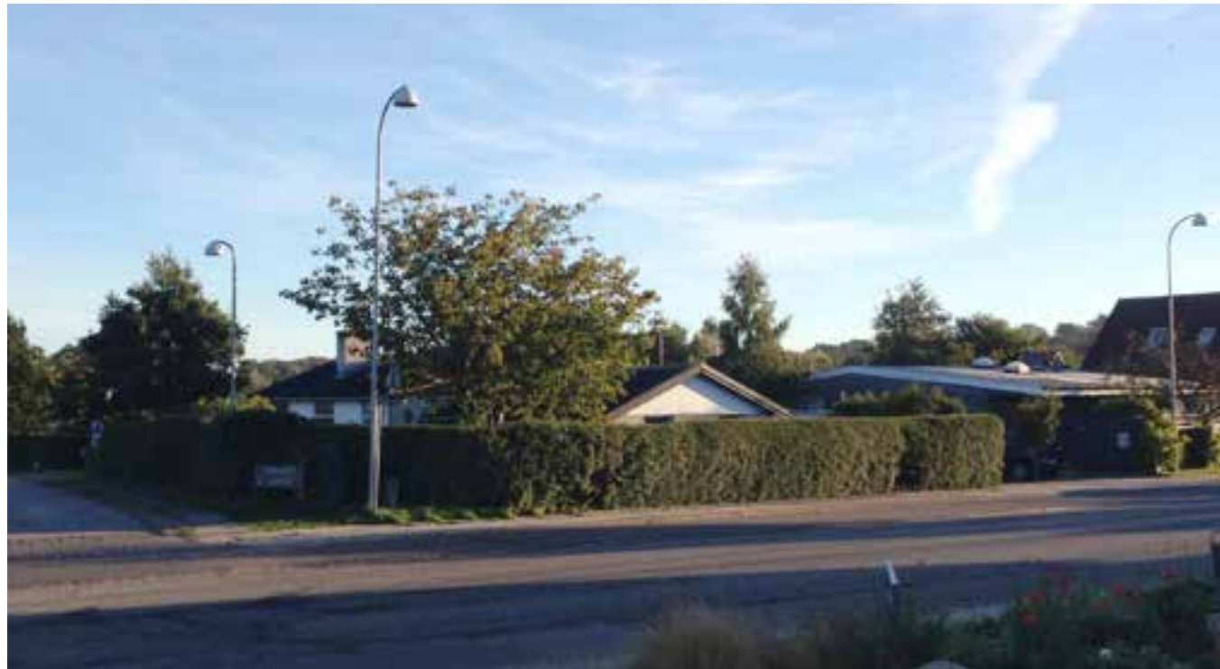
Genom olika stolphöjder kan man skilja olika gatutyper åt och berätta något om dem. Det finns också en röd tråd i stolparnas och armaturernas uttryck. Fotografi: ÅF Lighting
