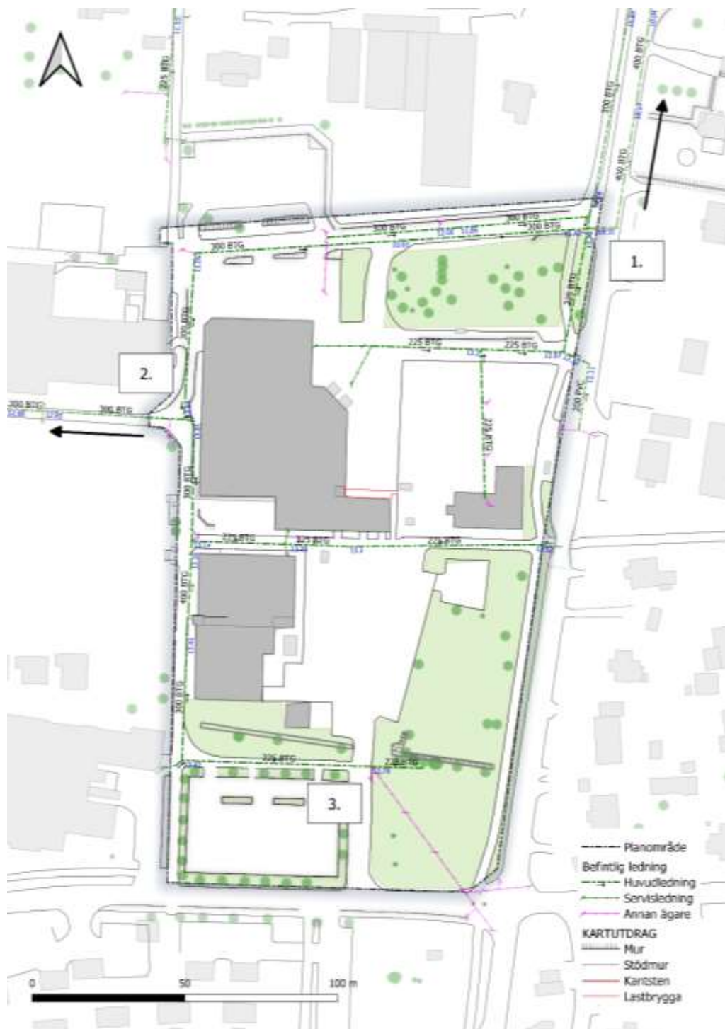
Figur 5 Utredningsområdet och befintliga dagvattenledningar.
