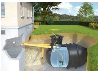
Figur 11. bild på regnvattentank, Avloppscenter
