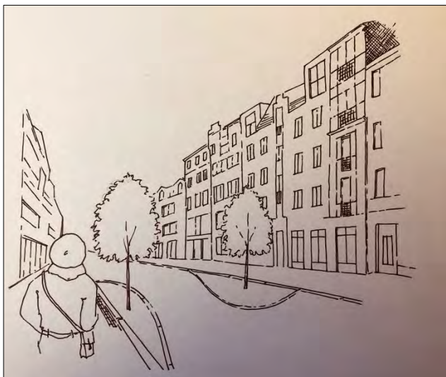
Principskiss över hur en avsmalning av vägbanan kan gestaltas i kombination med plantering av uppstammade gatuträd.
