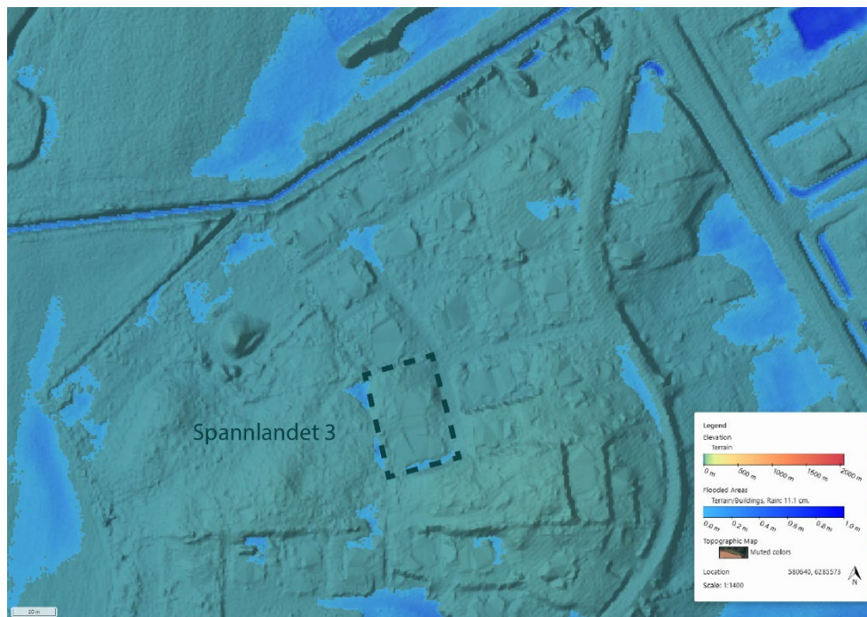
Figur 3 - utdrag ur Scalgolive som visar ett simulerat skyffall
