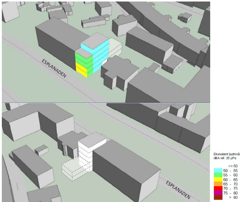
Mätning vid ekvivalent ljudnivå 2040. Tillkommande huskropp i streckat ingick ej i utförd mätning.
