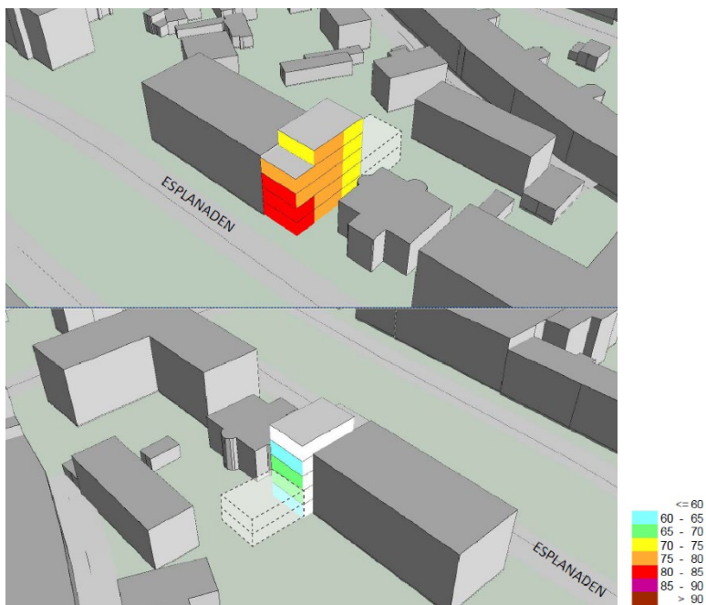
Mätning vid maximal ljudnivå. Tillkommande huskropp i streckat ingick ej i utförd mätning.
