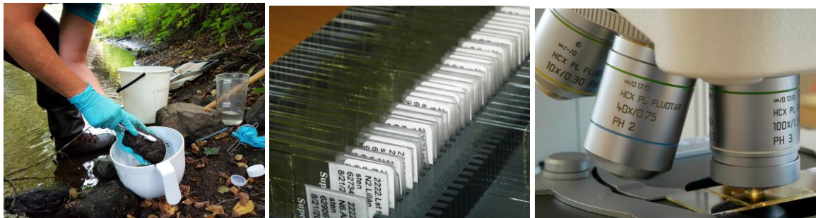
Figur 22. Provtagning av kiselalger görs i första hand från sten genom att påväxten borstas av. Om inte stenar finns eller om det t.ex. är för djupt, kan prov även tas från vattenväxter genom att växtdelar som befunnit sig väl under vattnet skakas, eller "tvättas" av. Kiselalgsskalen prepareras fram och fixeras på objektglas. Kiselalgssanalys görs i ljusmikroskop i 1000 gångers förstoring med oljeimmersionsobjektiv. Mikroskopet ska helst vara utrustat med interferenskontrast, vilket gör att man kan se mycket små former tydligare än med andra tekniker. © Medins Havs- och Vattenkonsulter AB.
