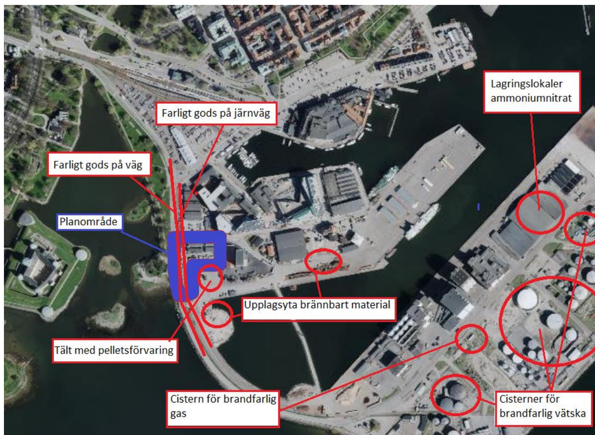
Figur 3.1. Aktuell planområde och närliggande riskobjekt.
